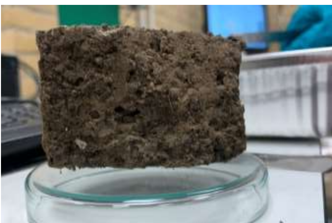
Figuur 6-7 Grond zonder vegetatie na Hyprop proef
