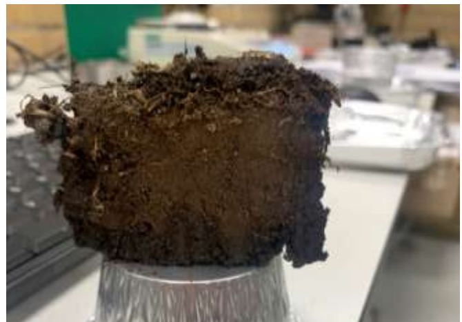
Figuur 6-8 Grond met vegetatie na Hyprop proef
