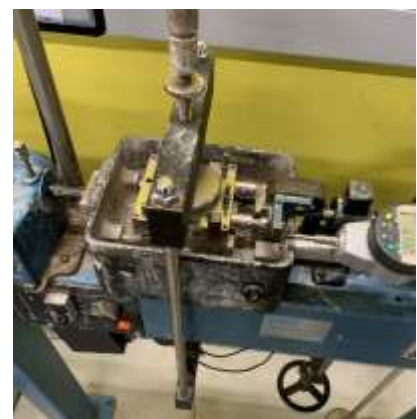
Figuur 3 Plaatsing van de verticale belasting
