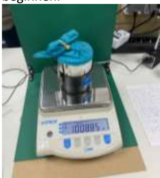
Grondmonster afgedekt laten stabiliseren
