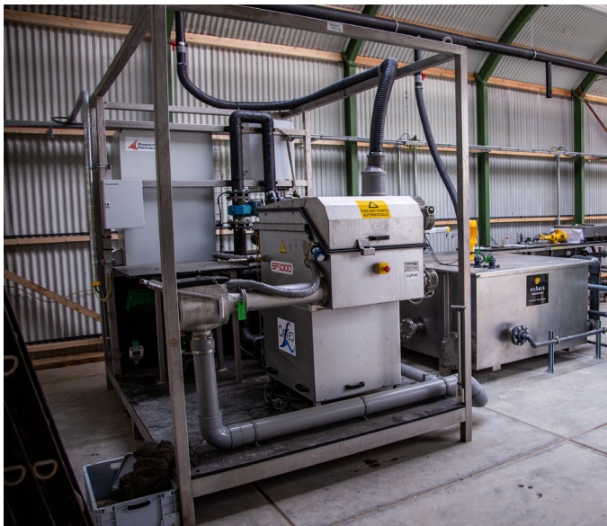
AFBEELDING 2.5 FIJNZEEF IN PROEFHAL
