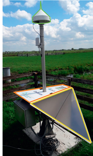
FIG. 3.4 EEN INTEGRATED GEODETIC REFERENCE STATION. ZOALS GEPLAATST IN ZEGVELD EN ROUVEEN. Groen-omlijnd is de GNSS-antenne, geel-omlijnd zijn te twee radarreflectoren en oranje-omlijnd de horizontale (referentie) plaat.
